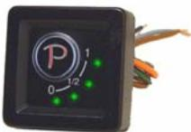
Транспортное средство всегда запускается при управлении на бензине и переключается автоматически на газ, когда правильный температурный набор условий в системе достигнут. LEDs вспыхивают вместе.
