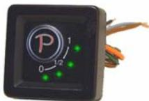
Транспортное средство всегда запускается при управлении на бензине и переключается автоматически на газ, когда правильный температурный набор условий в системе достигнут. LEDs вспыхивают вместе.
